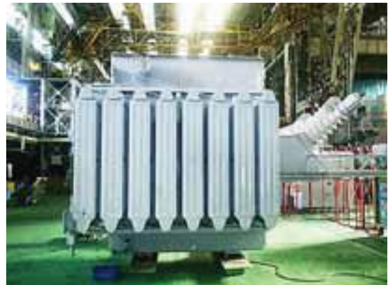
Рис. 22 Огнестойкий трансформатор 64,5 кВ 25 МВА с OLTC.
