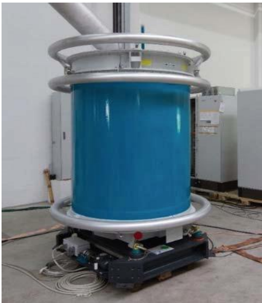
Рис. 14 Модули постоянного напряжения 400 кВ (слева) и 800 кВ (справа)
