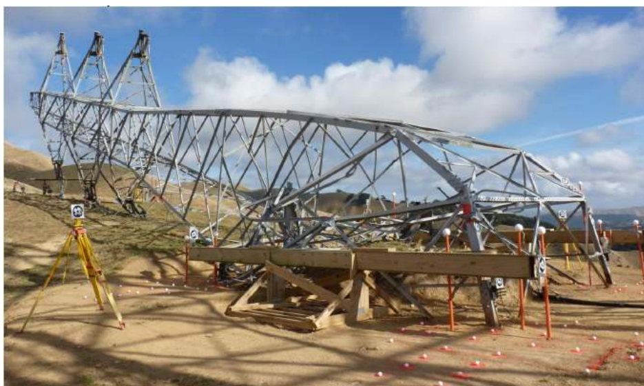
Рис. 8. Разрушение опоры в результате воздействия испытательных нагрузок
