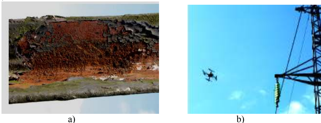
Рис.15. Применение БПЛА для обследования технического состояния ВЛ а- коррозия стальных уголков опоры, б – БПЛА в процессе обследования опоры
